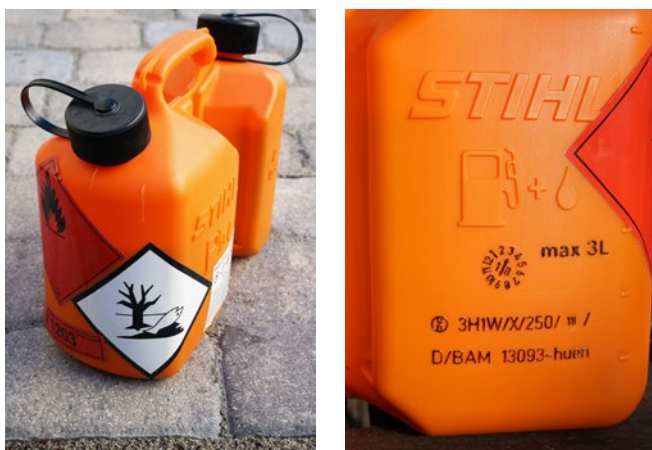
Abb. 3 Kunststoff-Kanister UN-codiert mit Prägestempel, BAM-Zulassung Herstellungszeitraum: März 2018
